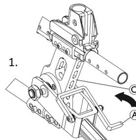
1. Rode a alavanca de segurança Ⓐ para a frente, junto do suporte de eixo ajustável Ⓒ.
